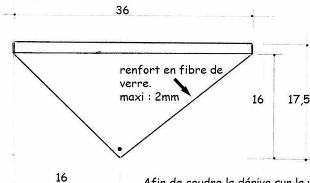
Coudre une bande de spi de 30mm x 36cm selon le schéma ci-dessous, l'ensemble forme un "T" qui sera cousu sur la voilure avant.
