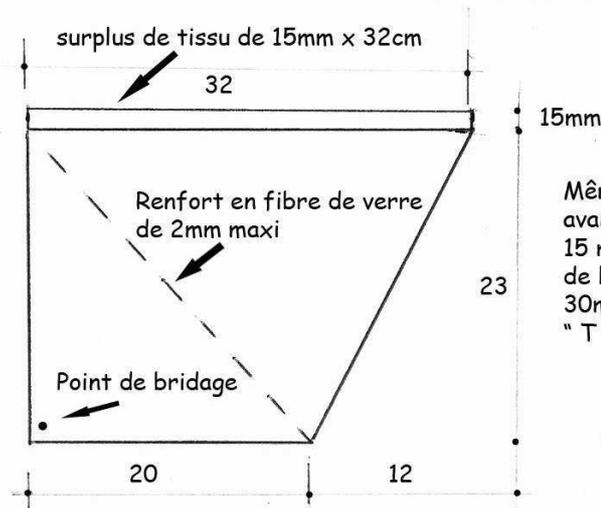
Même procédure que pour la dérive avant: prévoir un surplus de spi de 15 mm x 32 cm au départ du gabarit de la dérive, ainsi qu'une bande de 30mm x 32 cm afin de former le "T" qui sera cousu sur l'aile arrière.
